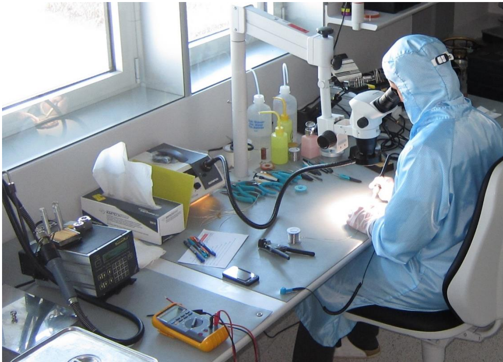
Copyright © IWF/ÖAW - Fluginstrumente, die im Weltraum zum Einsatz kommen, müssen zuverlässig und einwandfrei über die gesamte Missionsdauer - – oft mehr als zehn Jahre - – funktionieren. Dafür werden sie im Labor unter Weltraumbedingungen auf Herz und Nieren geprüft und in staubfreien Räumen vom technischen Personal in Schutzbekleidung zusammengebaut.
